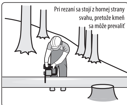
Priečne rezanie/skracovanie kmeňa, obr. 16
